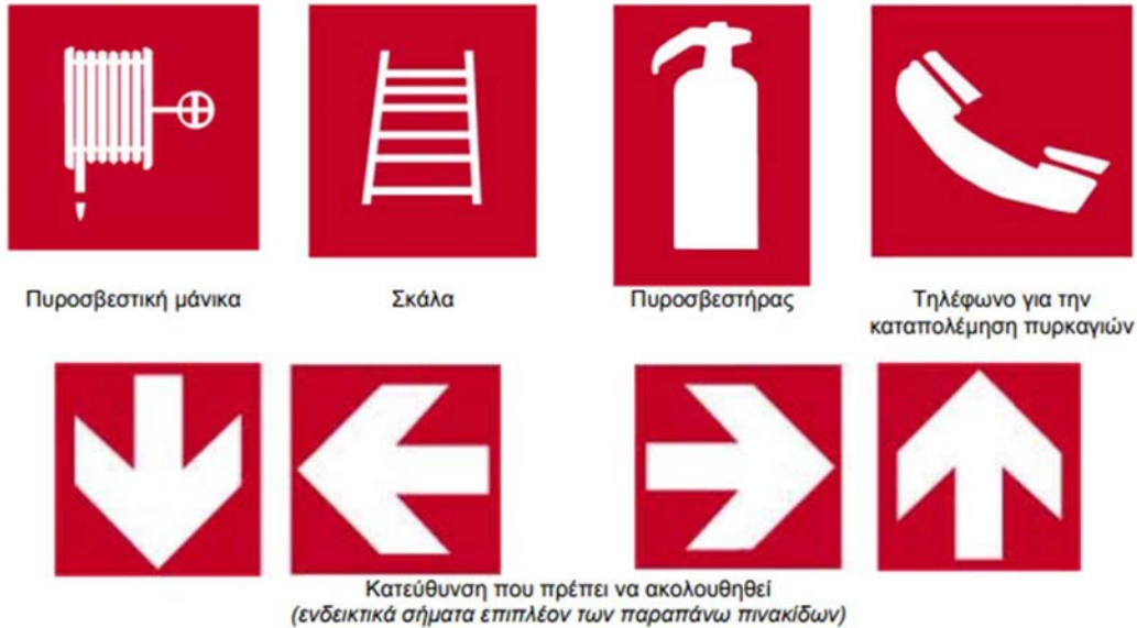
Εικόνα 32: Πινακίδες που αφορούν το πυροσβεστικό υλικό ή εξοπλισμό
