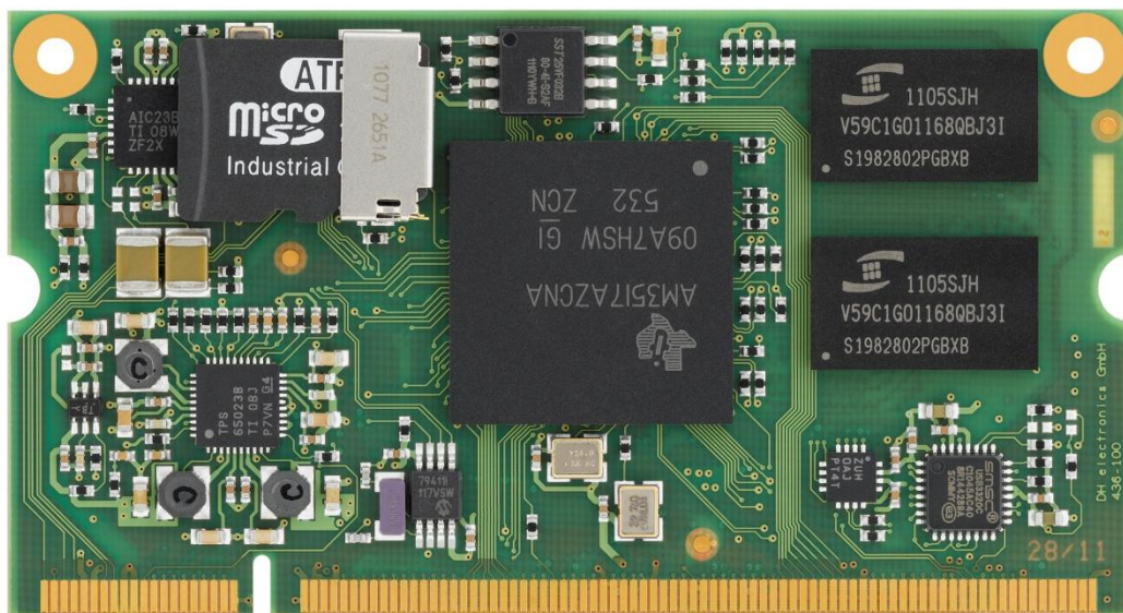
Εικόνα 1: Ενσωματωμένο σύστημα σε κάρτα με επεξεργαστή, μνήμη, τροφοδοτικό και εξωτερικές διεπαφές ( https://shorturl.at/46pso )
