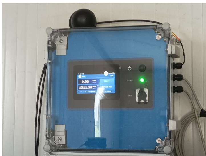
Εικόνα 12. Φορητός αναλυτής νιτρικών ιόντων (NO x -monitrix Mobile, Aquamonitrix Ltd., Tullow, Carlow, Ιρλανδία).
