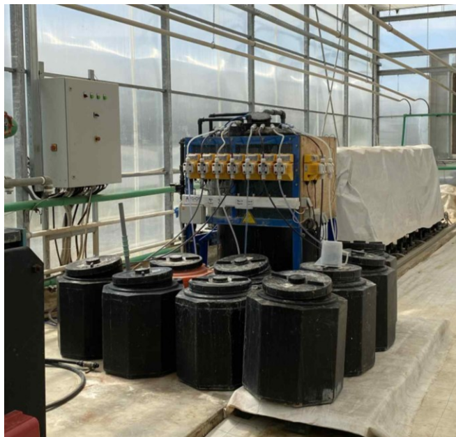
Εικόνα 8. Μονάδα αυτοματοποιημένης λίπανσης για την παραγωγή θρεπτικών διαλυμάτων
