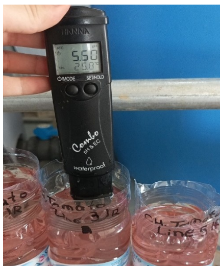
Εικόνα 11. Μέτρηση pH, EC και θερμοκρασίας του διαλύματος άρδευσης και απορροής της πρωτεύουσας και δευτερεύουσας καλλιέργειας με ειδικό φορητό, αδιάβροχο όργανο (Combo by Hanna, USA)
