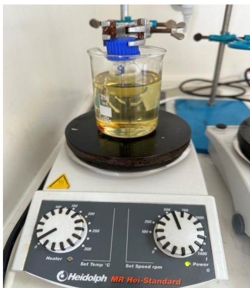
Εικόνα 8. Εκχύλιση με ανάδευση.
