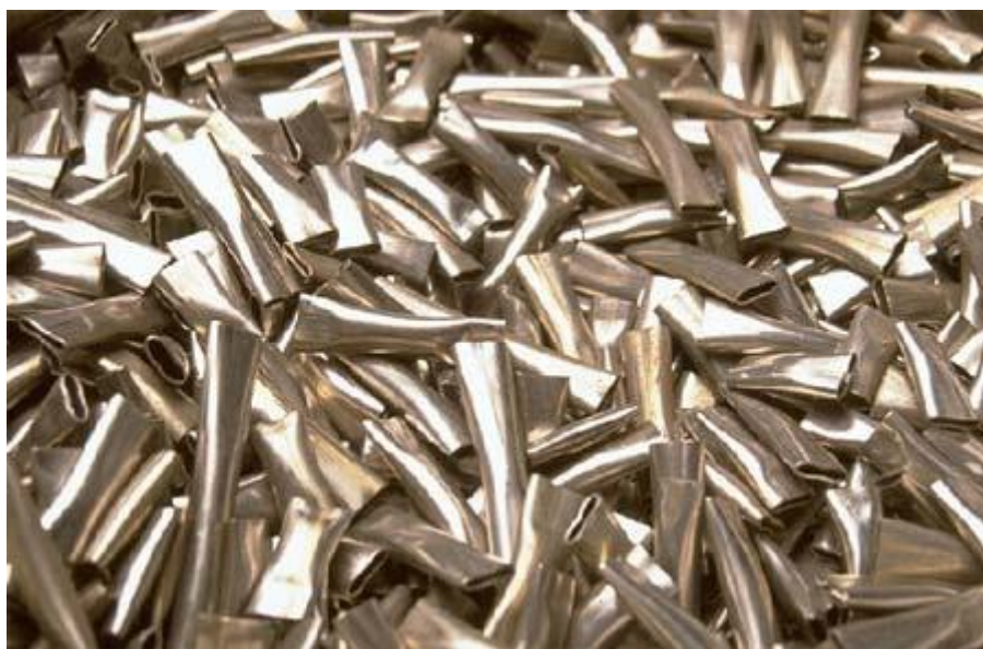
Εικόνα 23: Τεμαχισμένα υπολείμματα επένδυσης Zircaloy (εξωτερικό περίβλημα ράβδων καυσίμου), που περιβάλλει τα πέλλετ καυσίμου σε αντιδραστήρες, τα οποία δέχονται για πάνω από 2 χρόνια, την ραδιενέργεια που εκπέμπεται κατά την σχάση. Θεωρούνται συνήθως πυρηνικά (ραδιενεργά) απόβλητα μεσαίου επιπέδου (ILW) (Πηγή: Radioactivity.eu.com).
