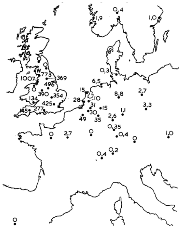
Εικόνα 21: Ποσά ραδιενέργειας που εντοπίστηκαν στην ατμόσφαιρα, ύστερα από το πυρηνικό ατύχημα στο Windscale της Μεγάλης Βρετανίας. Η μέτρηση είναι στην παλαιότερη μονάδα μέτρησης mCi/m 3 . (πηγή: F. Loutit, G. Marley, S. Russel, The Nuclear Reactor Accident at Windscale-October, 1957: Environmental Aspects ).
