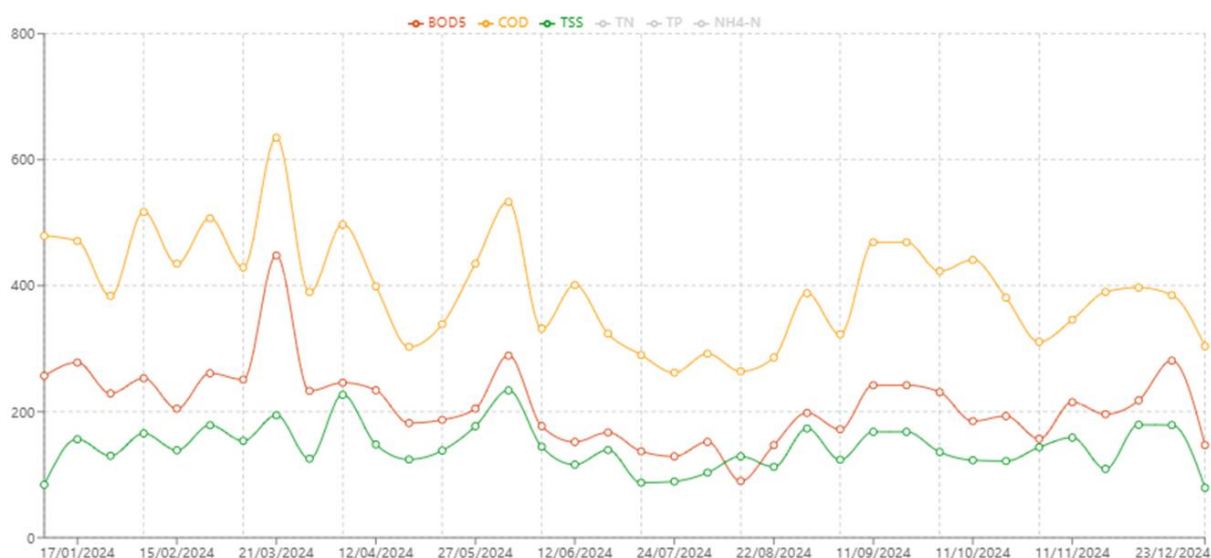
Διάγραμμα 8α. Μηνιαία μεταβολή οργανικών φορτίων και αιωρούμενων στερεών (BOD 5 , COD, TSS) στην είσοδο της εγκατάστασης επεξεργασίας λυμάτων
