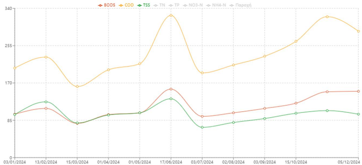
Διάγραμμα 9α. Μηνιαία μεταβολή οργανικών φορτίων και αιωρούμενων στερεών (BOD 5 , COD, TSS) στην είσοδο της εγκατάστασης επεξεργασίας λυμάτων
