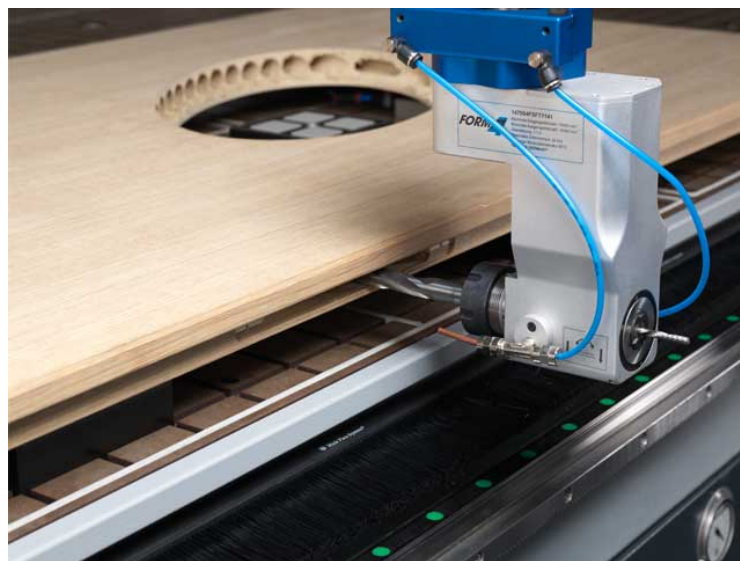
Εικόνα 3.5 Τεμάχιο στην διαδικασία της διάτρησης [3]
