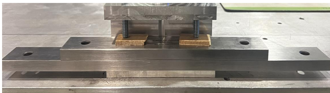
Εικόνα 22: Συστοιχία πρότυπων πλακιδίων για την επαλήθευση του βραχίονα
