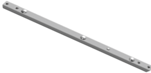
Εικόνα 9: Διακριθωμένη μπάρα για τον έλεγχο αρθρωτού βραχίονα (Πηγή: https://www.verisurf.com/blog/article/portable-cmm-arm-accessories/ )
