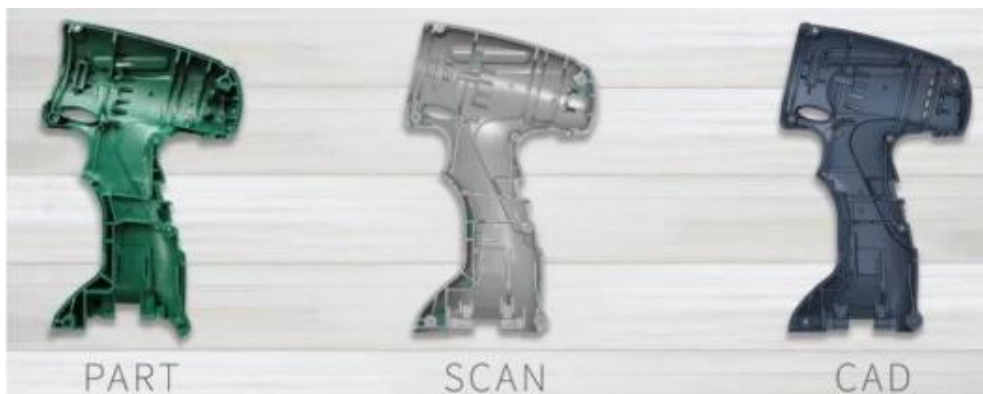
Εικόνα 26: Οι τρεις φάσεις της αντίστροφης σχεδίασης(Αζαριαδης-τοπαλογλου Φ. et al., 2023)
