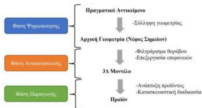
Εικόνα 25: Διάγραμμα αντίστροφης σχεδίασης (Αζαριάδης-Τοπάλογλου Φ. et al., 2023)
