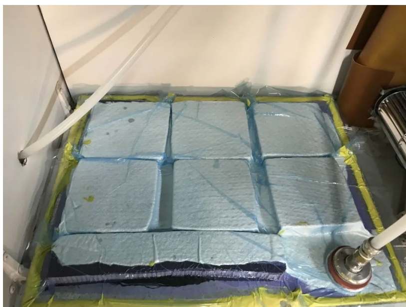
Σχήμα 3. Συναρμολόγηση καλουπιού θερμού κύκλου κενού.
