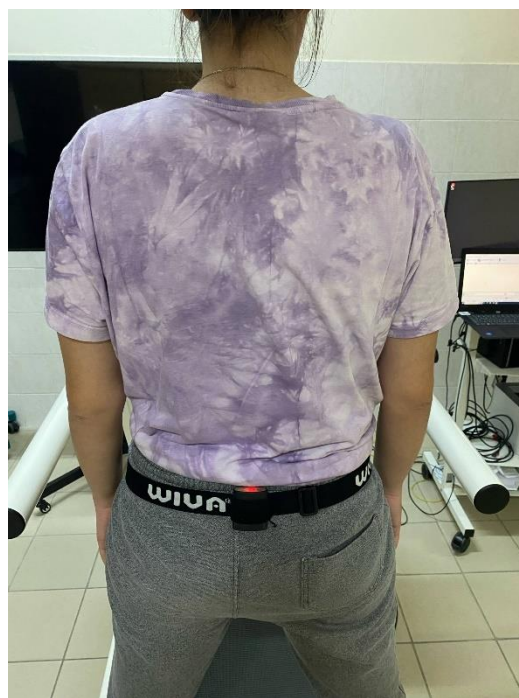
Εικόνα 3.8 Θέση αισθητήρα κίνησης WIVA
