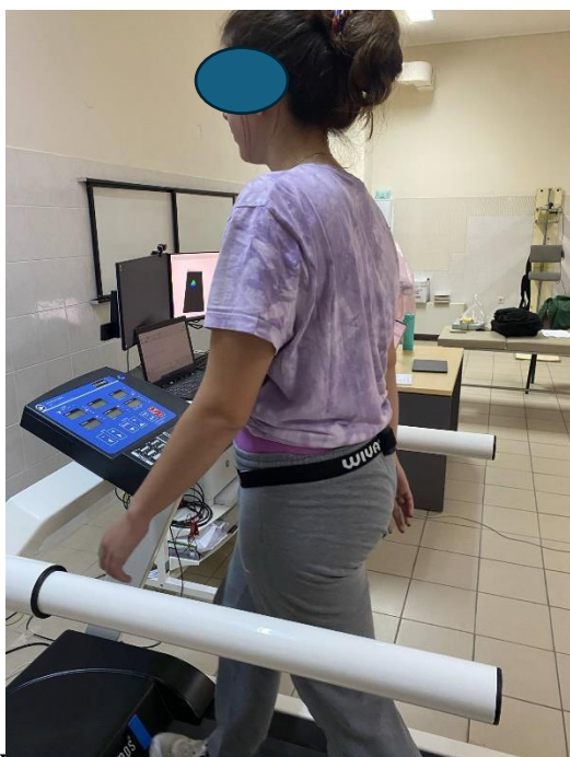
Εικόνα 3.11 Διαδικασία μέτρησης εγκυρότητας αισθητήρα κίνησης WIVA
