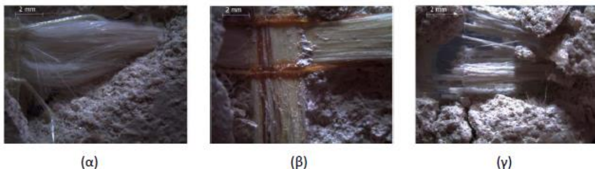
Εικόνα 23 : Κατάσταση ινών ύστερα από την αστοχία του IAM
