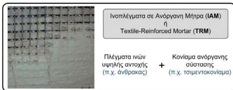
Εικόνα 1 : Περιγραφή Ινοπλέγματος Ανόργανης Μήτρας
