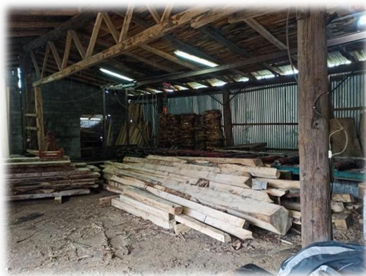
Εικόνα 32. Δοκάρια και ξυλεία μεγάλων διαστάσεων τοποθετημένα σε καλυμμένο χώρο με φυσικό εξαερισμό
