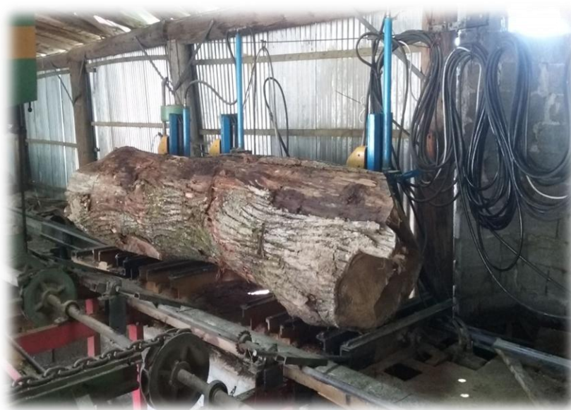
Εικόνα31. Κορμός καστανιάς τοποθετημένος σε ταινιοπρίονο κορδέλα για την έναρξη της πρίσης. Πρώτο στάδιο επεξεργασίας σε τοπική μονάδα του Πηλίου
