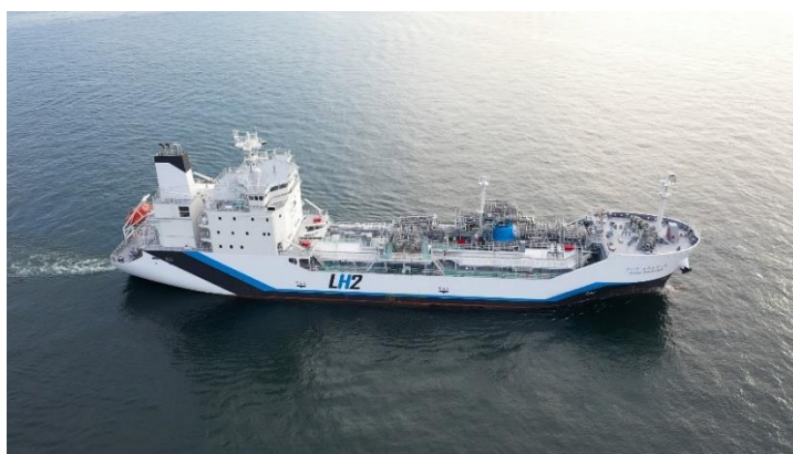
Εικόνα 26: Hystra Project for LH 2 Transport, 1250 m 3 Cryogenic Tank Πηγή: (“IMAGE 26” 2024)
