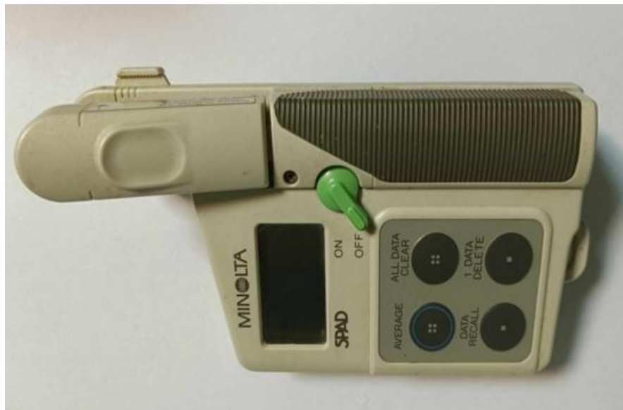
Εικόνα 2.2. Όργανο μέτρησης χλωροφύλλης SPAD-502 chlorophyll meter (Konica Minolta Optics Inc.) σε τιμές SPAD.
