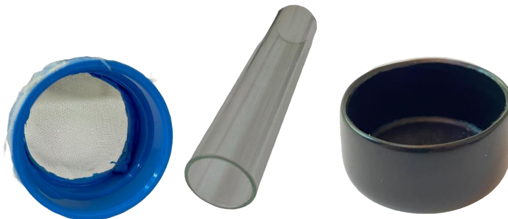
Εικόνα 25: Εξαρτήματα του συστήματος LAM. Από αριστερά προς τα δεξιά: καπάκι με προσαρμοσμένη οργαντίνα - γυάλινος κυλινδρικός σωλήνας - πόμα τροφής από βινύλιο (Φωτ. Αθανάσιος Παρισάκης).
