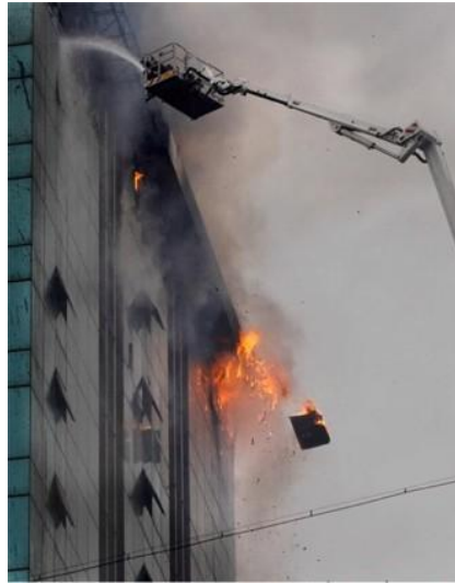
Σχήμα 4.2: Πτώση υαλοπινάκων από πυρκαγιά διαμερίσματος.
