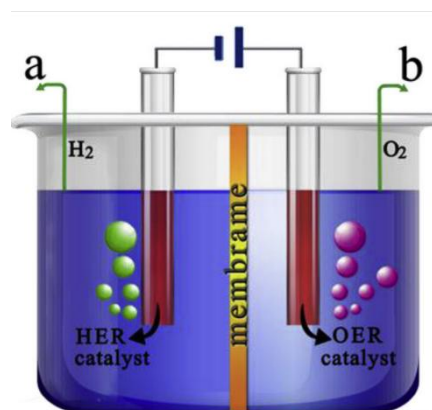
Εικόνα 21 Σχήμα συστήματος δύο ηλεκτροδίων για συνολική διάσπαση νερού [53].
