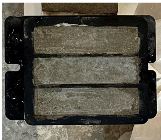
Σχήμα 3.4 Πρίσματα για τον προσδιορισμό μηχανικών χαρακτηριστικών τσιμεντοειδούς κονιάματος
