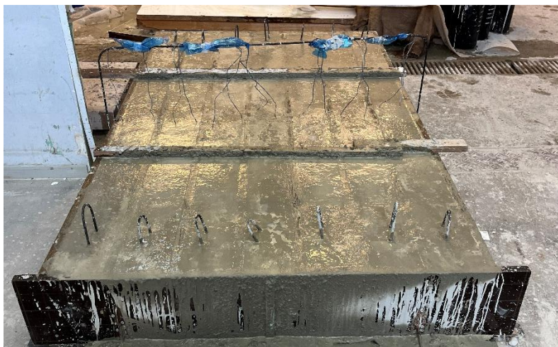
Σχήμα 3.9 Δοκίμια κατά τη σκυροδέτηση
