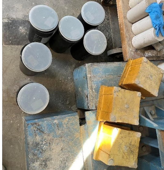
Σχήμα 3.10 Μήτρες για τη λήψη δοκιμών σκυροδέματος
