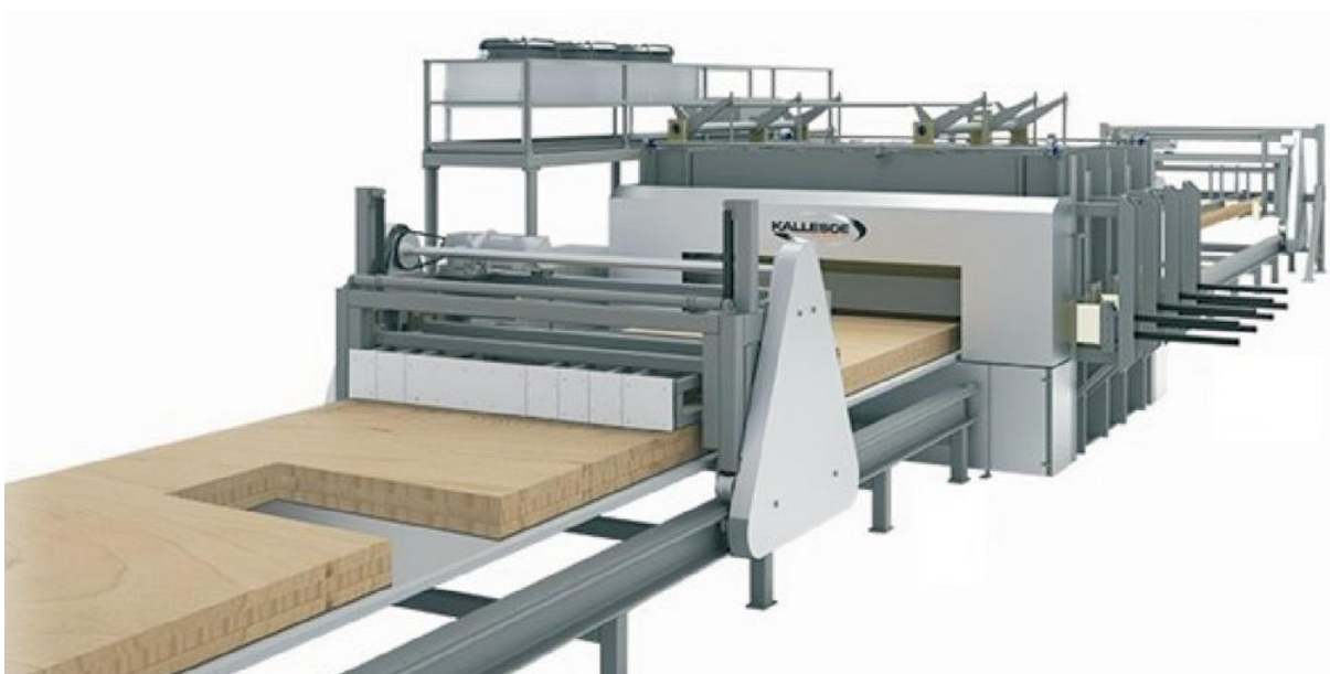
Εικόνα 6: Γραμμή παραγωγής πάνελ CLT
