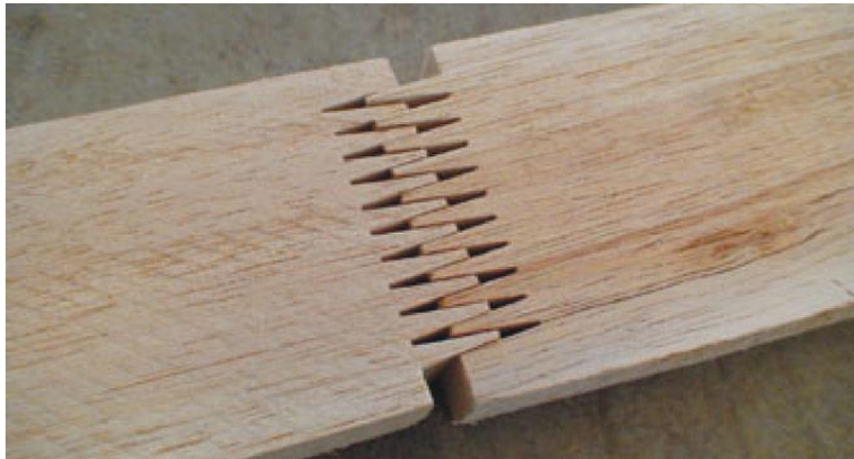
Εικόνα 5: Δακτυλικός αρμός ξυλίας (finger joint)
