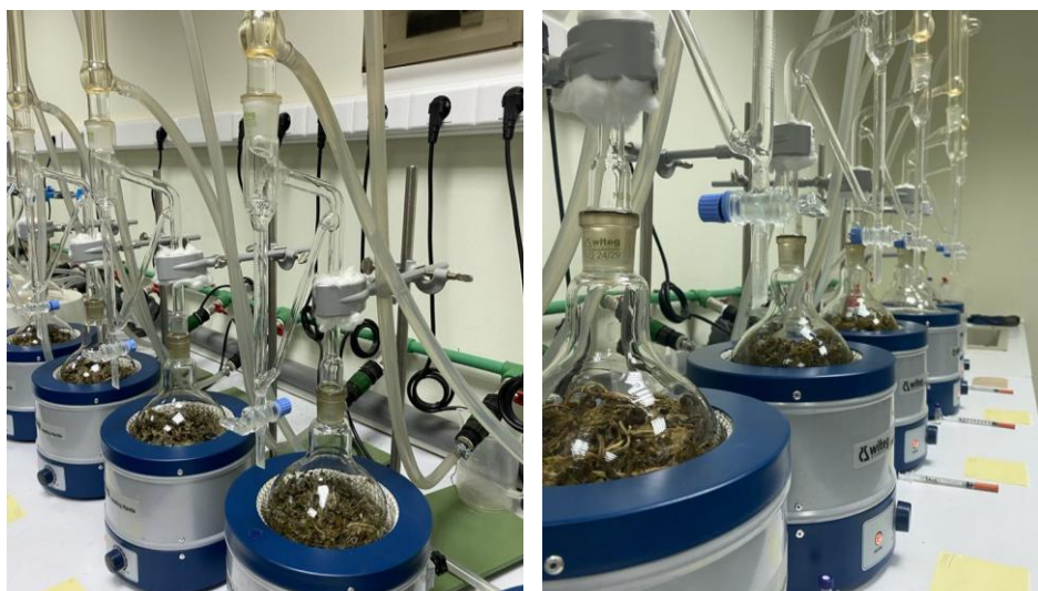
Εικόνα 2.9.1 & 2.9.2: Αποστακτικές συσκευές Clevenger του Εργαστηρίου Γεωργίας σε χρήση
