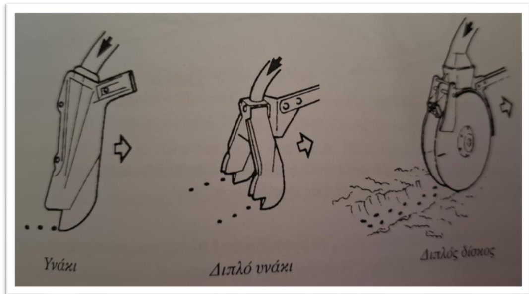
Εικόνα 11. Είδη συστήματος διάνοιξης της αυλακιάς (Τσατσαρέλης, 2000).
