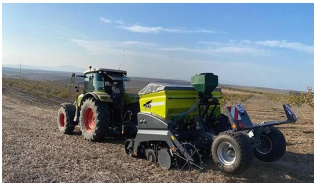
Εικόνα 7. Ευέλικτη σπαρτική μηχανή σ' όλες τις συνθήκες, δηλαδή σε καλλιεργημένα, ακαλλιεργητα (no till), αλλά και πάνω σε ήδη υπάρχουσες καλλιέργειες, όπως π.χ. σπορά σιτηρών σε συνδυασμό με ψυχανθή για εμπλουτισμό εδάφους στο Ζάππειο Λάρισας το 2021 ( https://giorgoskatsadonis.blogspot.com/ ).
