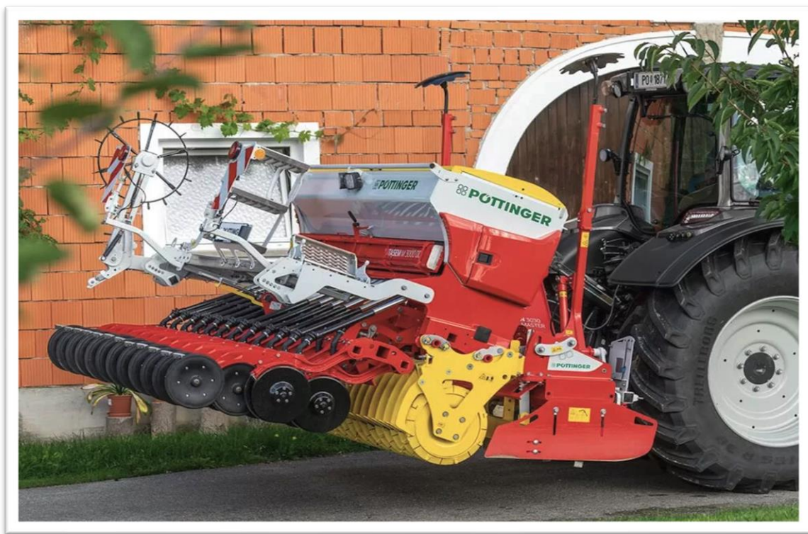
Εικόνα 24. Σύγχρονη Σπαρτική Μηχανή Vitsem της Pöttinger ( https://profi.gr/ ).
