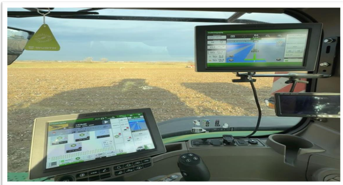
Εικόνα 28. Οθόνες σε σύγχρονο τρακτέρ όπου μέσω των αισθητήρων και του GPS πραγματοποιείται η σπορά ακριβείας (προσωπικό αρχείο).
