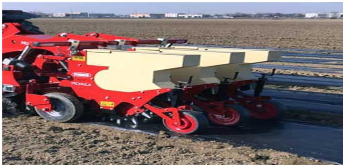
Εικόνα 20. Σπαρτική μηχανή με συνδεδασμένο πλαστικό σπόρο στρώσεων, το οποίο επιτρέπει την τοποθέτηση του πλαστικού και του σπόρου απευθείας μέσω αυτού σε μία δίοδο εργασίας. ( https://www.panagrotiki.gr/ ).
