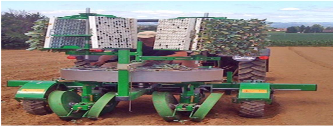
Εικόνα 18. Η ημι-αυτόματη μηχανή τύπου φυτευτηρίων SFOGGIA F/C – 18 για τομάτα, καπνό και λάχανο ( https://anagnou.gr/ ).
