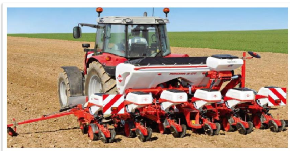
Εικόνα 8. Σπαρτική ανοιζιάτικων καλλιεργειών με 6 γραμμές και γραμμοχαράκτες καλαμποκιού (Κατέρης, 2015).
