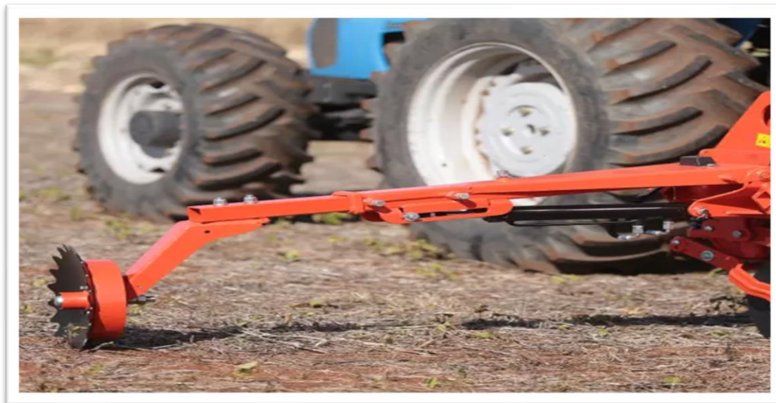
Εικόνα 17. Γραμμοχαράκτης σε σπαρτική μηχανή ( https://www.kuhn.com/ ).
