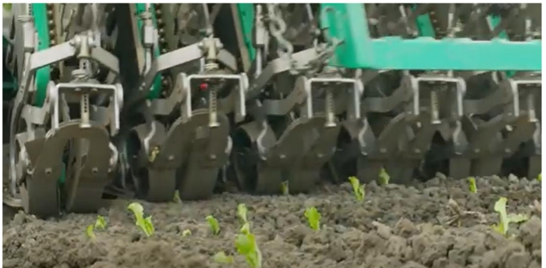
Εικόνα 19. Σπαρτική μηχανή τύπου φυτευτηρίου (Plantape, 2024)
