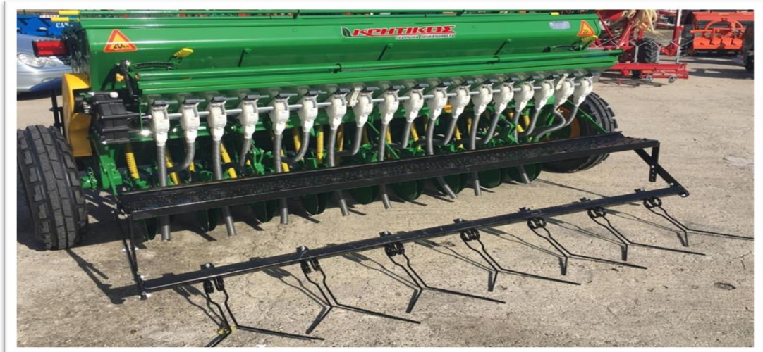
Εικόνα 14. Ελκόμενη σπαρτική μηχανή με διπλούς δίσκους και τριπλό καζάνι. Κατάλληλη για όλους τους σπόρους καθώς και για μικρούς λεπτούς σπόρους μικρών γραμμαρίων ( https://kritikos-sa.com/ ).
