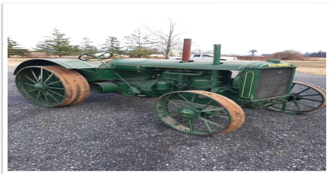
Εικόνα 4. Ο πρώτος γεωργικός ελκυστήρας περιορισμένης χρήσεως το 1928 που έκαιγε κηροζίνη από την εταιρεία Allis Chalmers στις Η.Π.Α. ( https://tractorzoom.com/ ).
