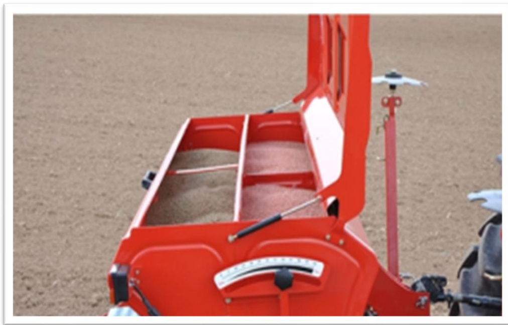
Εικόνα 13. Σπαρτική μηχανή σιτηρών με ξεχωριστά δοχεία για τον σπόρο και το λίπασμα (Γέμτος & Καβαλάρης, 2015).
