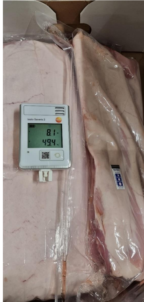
Εικόνα 2.5: Καταγραφικό θερμοκρασίας σε δείγμα Πανσέτας και ο ενεργοποιημένος TTI.
