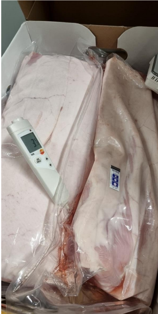
Εικόνα 2.4: Θερμομέτρηση δειγμάτων Πανσέτας με το θερμόμετρο ακίδας Testo 106 και ο ενεργοποιημένος TTI.
