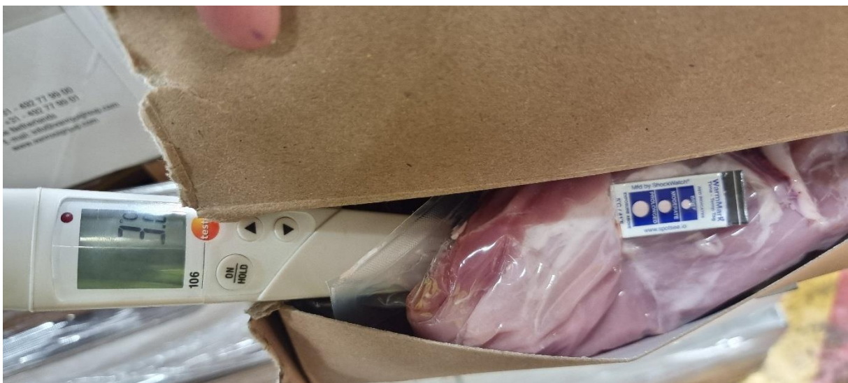
Εικόνα 2.6: Θερμομέτρηση δειγμάτων Χοιρινού Φιλέτου με το θερμόμετρο ακίδας Testo 106 και ο ενεργοποιημένος TTI.
