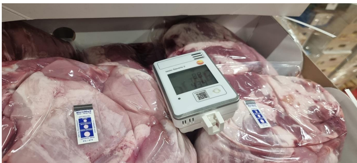
Εικόνα 2.10: Καταγραφικό θερμοκρασίας δειγμάτων Σπάλας στο κέντρο διανομής και ο ενεργοποιημένος TTI.
