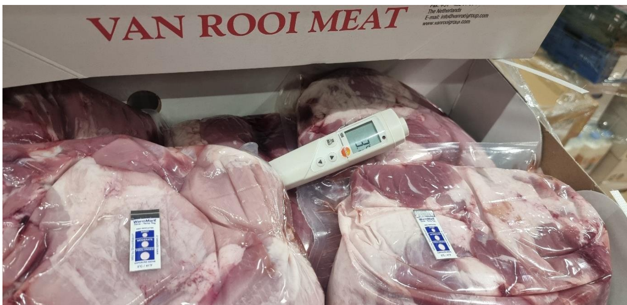
Εικόνα 2.9: Θερμομέτρηση δειγμάτων Σπάλας με το θερμόμετρο Testo 106 και ο ενεργοποιημένος TTI.
