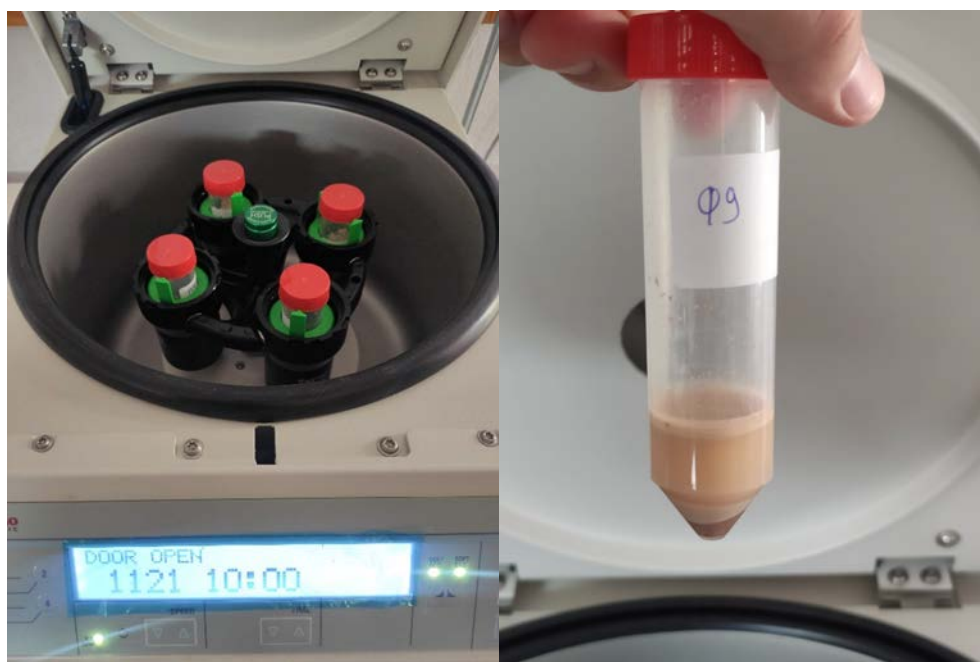
Εικόνα 9: Φυγοκέντριση με αρθρωτή κεφαλή 4 θέσεων για FALCON 15mL - 50mL και ίζημα (Προσωπικό αρχείο)
