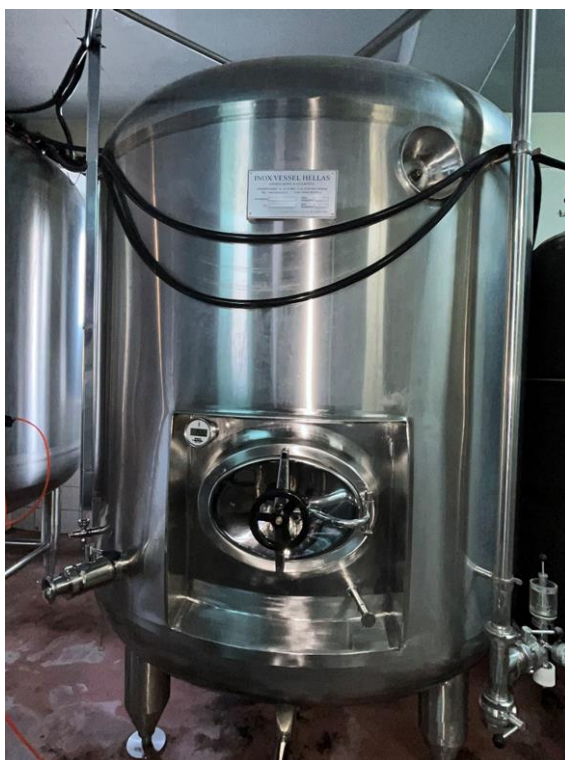
Εικόνα 12: Δεξαμενή παραγωγής αφρώδες οίνου
