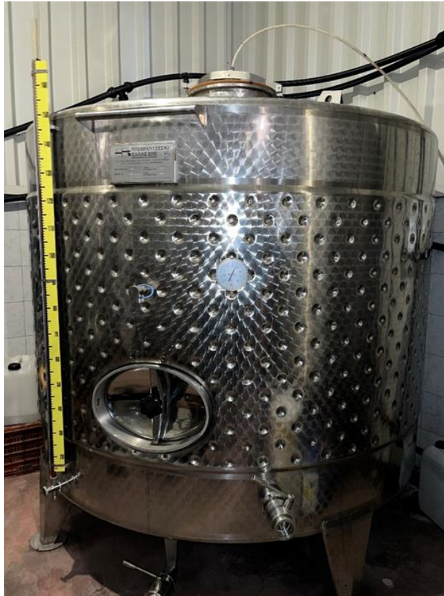
Εικόνα 10: Δεξαμενή αποθήκευσης οίνου
