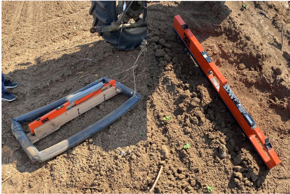
Εικόνα 15 & 16. Αριστερά: Η συσκευή EM38 μαζί με το πλαίσιο στο οποίο τοποθετήθηκε κατά την σάρωση του αγροτεμαχίου. Δεξιά: Η συσκευή EM38.
