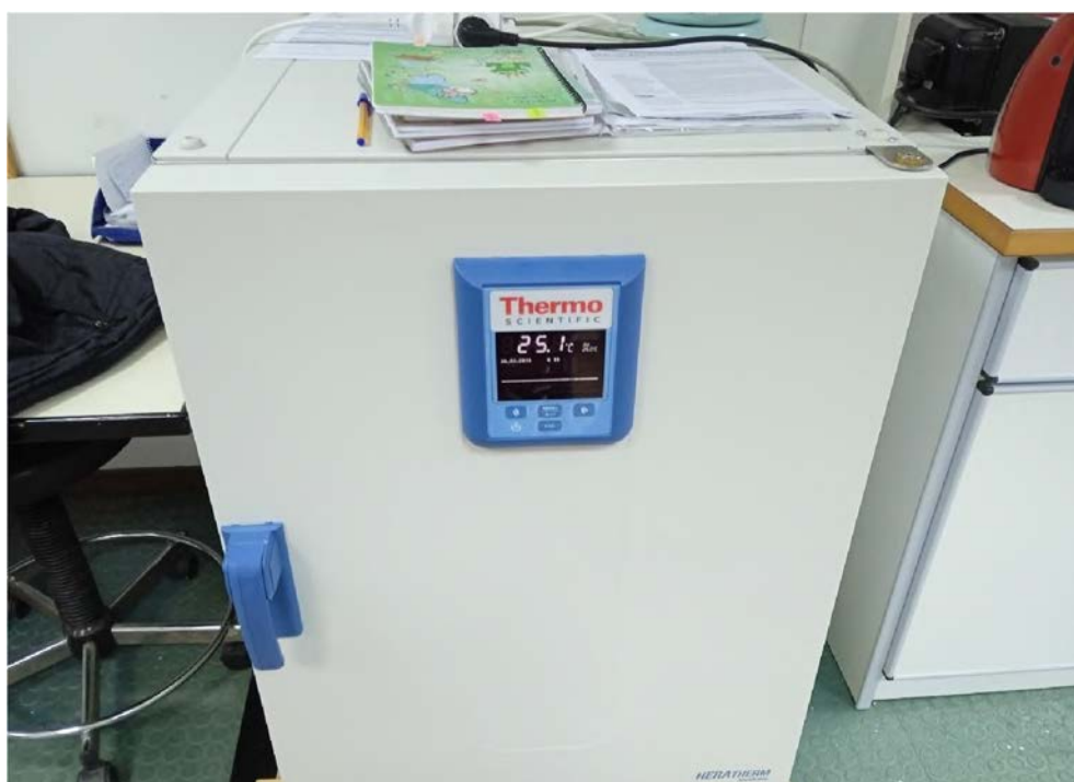
Εικόνα 20: Επωαστήρας όπου τοποθετούνται οι μύκητες για να αναπτυχθούν στο ιδανικό περιβάλλον.
