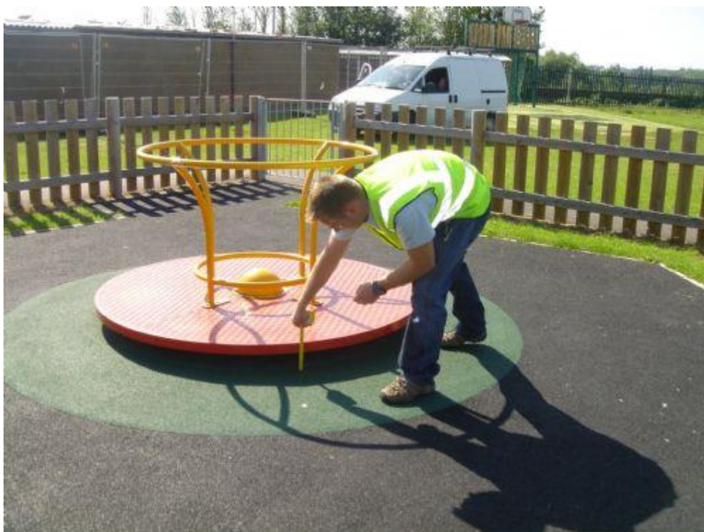
Εικόνα 66: Εξειδικευμένος υπάλληλος του φορέα επιτήρησης χρησιμοποιεί μέτρο για να επιβεβαιώσει ότι η απόσταση της βάσης του μύλου της παιδικής χαράς σε σχέση με το έδαφος είναι επαρκής
