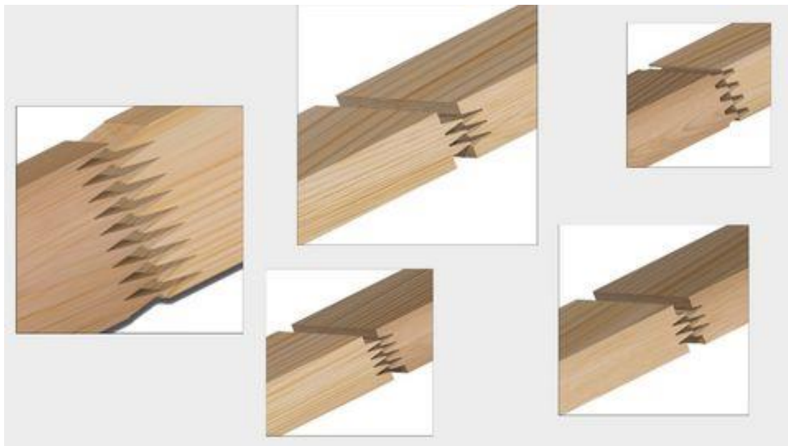
Εικόνα 54: Δακτυλοειδείς συνδέσεις ξυλείας πέντε διαφορετικών τύπων
