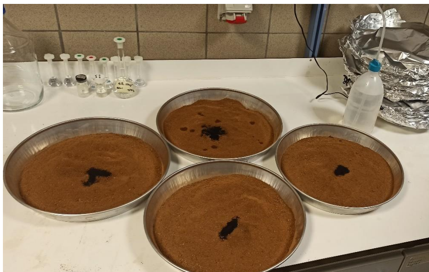
Εικόνα 2.3-1: Προσθήκη ποσότητας μικροπλαστικών στο έδαφος για προετοιμασία πειράματος μικροκόσμων.
