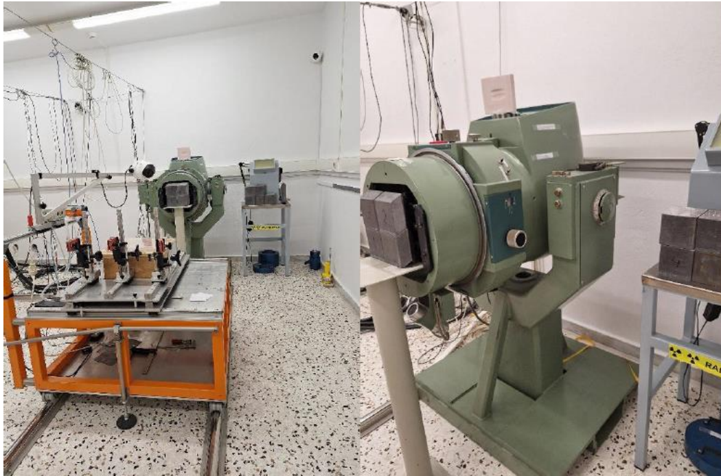
Εικόνα 7 Χώρος ακτινοβόλησης κουνουπιών στην Ελληνική επιτροπή ατομικής ενέργειας αριστερά φαίνεται το τραπέζι στο οποίο τοποθετείται το κουτί που περιέχει τα αρσενικά κουνούπια, ο οποίος κινείται πάνω σε ράγες ώστε να ρυθμίζεται η απόσταση ακτινοβόλησης, δεξιά φαίνεται ο ακτινοβολητής που εκπέμπει την ακτινοβολία
