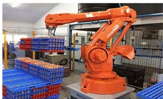
Εικόνα 10: Ρομπότ που χρησιμοποιούνται στην παλετοποίηση. Πηγή: Matache et al., 2022
