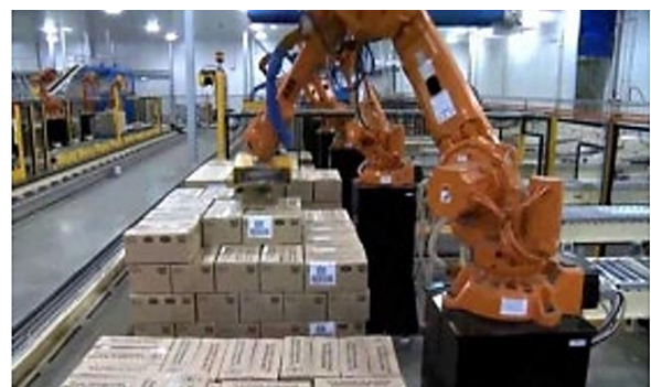
Εικόνα 10: Ρομπότ που χρησιμοποιούνται στην παλετοποίηση. Πηγή: Matache et al., 2022
