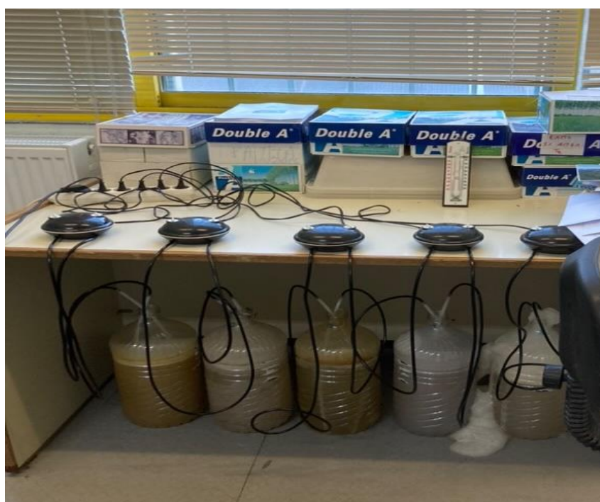
Εικόνα 13 : Καλλιέργεια του μικροφύκου Chlorella sorokiniana υπό ετεροτροφικές συνθήκες με διαφορετικές πηγές άνθρακα. Οι φιάλες συνδέονται με σύστημα συνεχούς παροχής αζώτου. Η πειραματική διάταξη βρίσκεται σε ελεγχόμενο περιβάλλον για τη διατήρηση σταθερών συνθηκών ανάπτυξης.
