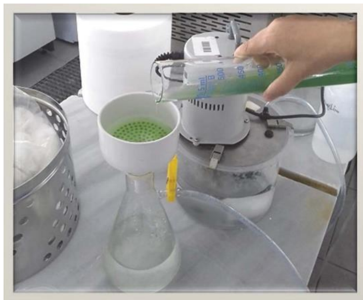
Εικόνα 3: Αντλία κενού και φίλτρο προκειμένου να συλλεχθεί η υγρή μάζα των νηματοειδών κυανοβακτηριακών μικροφυκών
