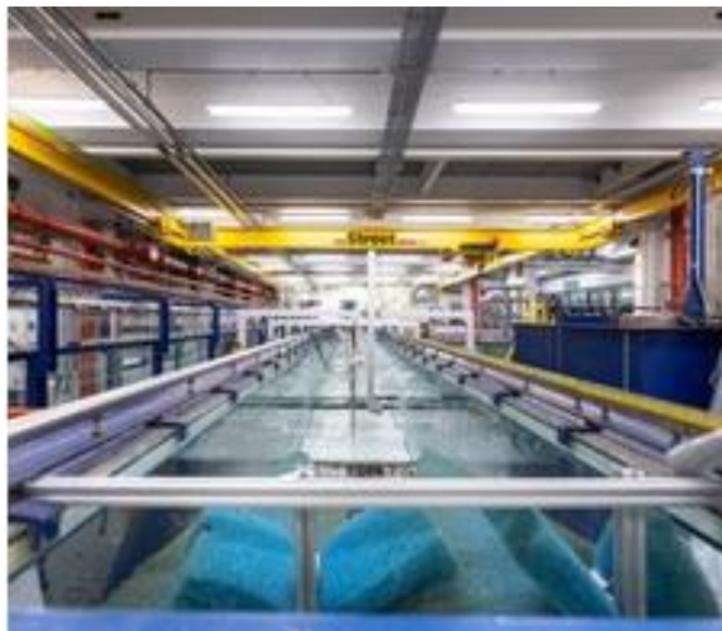
Εικόνα 9: Η coastal flume του κολεγίου Imperial College, London
