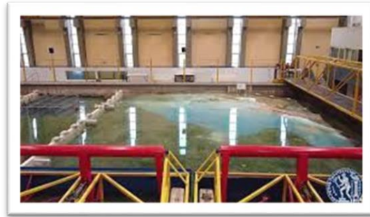
Εικόνα 2: Δεξαμενή του εργαστηρίου λιμενικών έργων του Εθνικού Μετσόβιου Πολυτεχνείου
