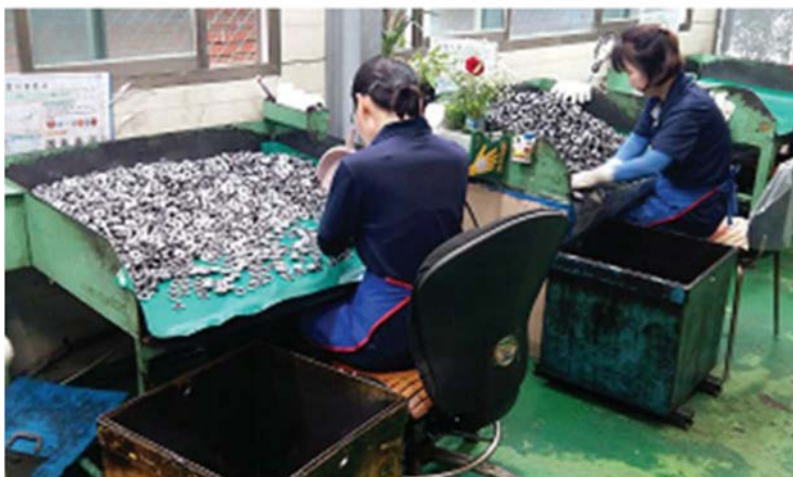
Εικόνα 17. Φυσική επιθεώρηση των παξιμαδιών συγκόλλησης από τους εργαζομένους [13]
