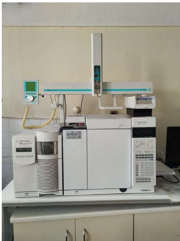
Εικόνα 14 Σύστημα αέριου χρωματογράφου συζευγμένο με φασματογράφο μάζας.
