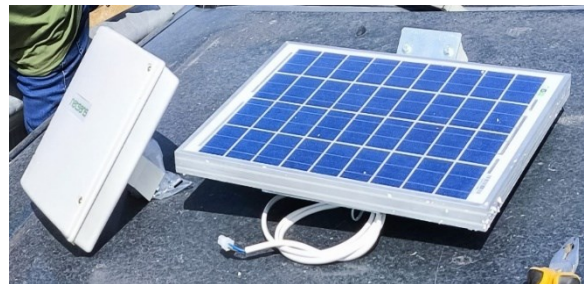
Εικόνα 9 Ηλιακός συλλέκτης και ηλεκτρονική μονάδα επικοινωνίας
