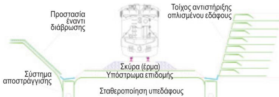
Εικόνα 21. Σχήμα βασικών εφαρμογών γεωσυνθετικών σε σιδηροδρομικά έργα (IGS, 2023b)
