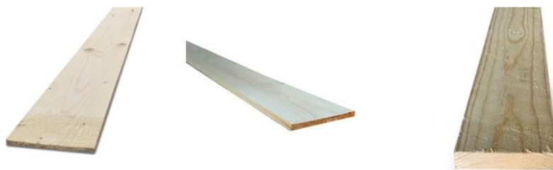
Εικόνα 2.7: Απλάνιστες σανίδες ελάτης, αριστερά σκουρέτο πάχους 12mm, μέση μισόταβλα πάχους 18mm, δεξιά τάβλα πάχους 22mm.
