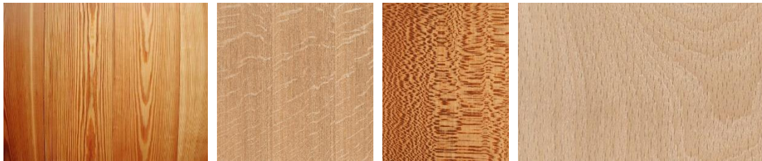
Εικόνα 2.13: Ξύλο πεύκου με φαρδύβεννα και ισόβεννα νερά, Ξύλο δρυός σε ακτινική τομή με χρυσαλίδα, Ξύλο πλατανιού σε ακτινική τομή με δαντέλα, Ξύλο οξιάς σε ακτινική τομή με βροχή. (Από αριστερά προς τα δεξιά)
