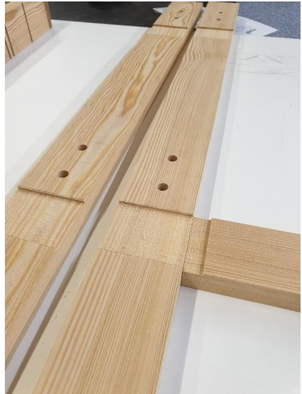
Εικόνα 5.26: Δημιουργία ποταμών στο κατακόρυφο στοιχείο του σώματος και στο οριζόντιο στοιχείο του ποδιού.
