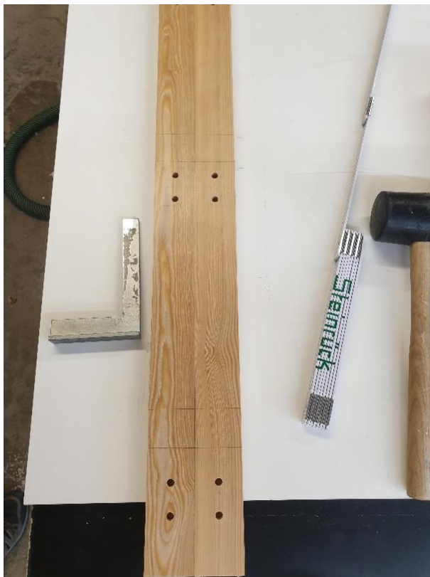
Εικόνα 5.21: Τρύπες που έγιναν στα κατακόρυφα στοιχεία για τις τραβέρσες.
