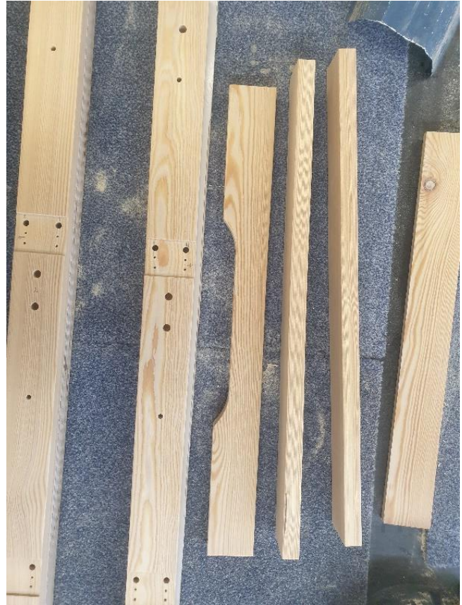
Εικόνα 5.42: Τραβέρσες και κατακόρυφα στοιχεία.
