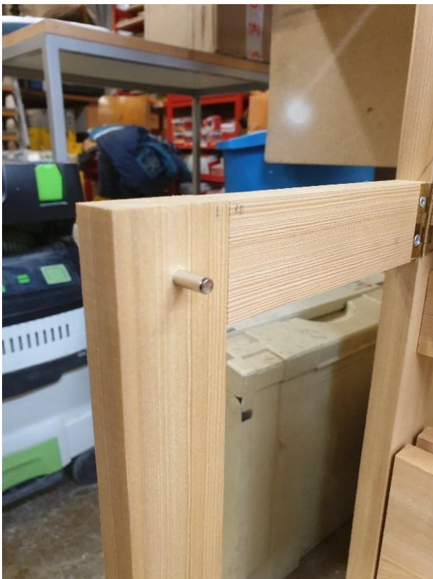
Εικόνα 5.35: Πείρος στοπ για να πατάει η επιφάνεια.
