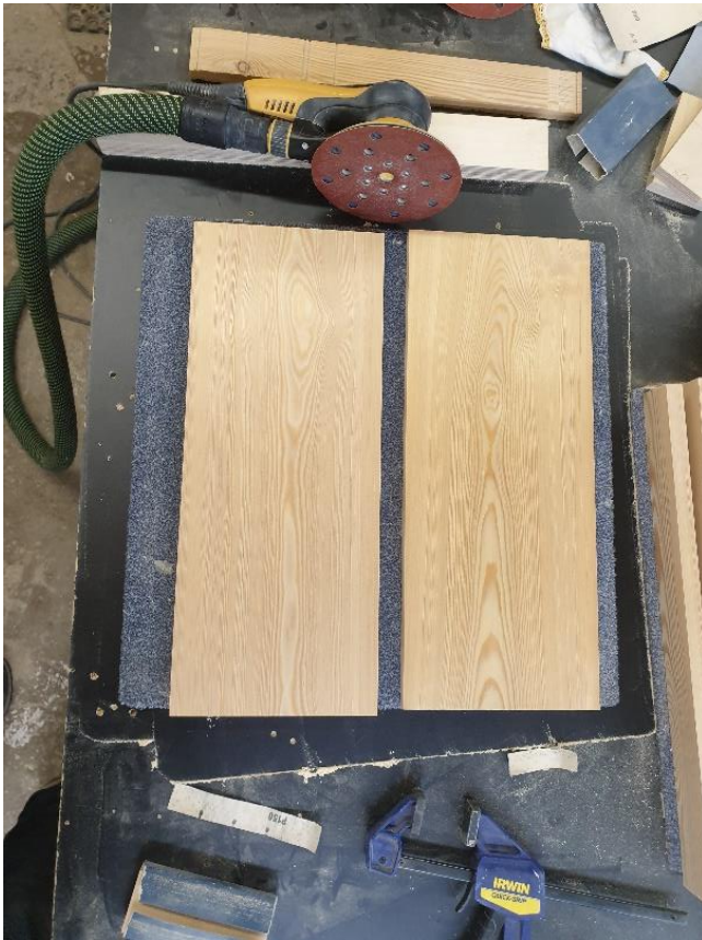
Εικόνα 5.47: Τρίψιμο των μεγάλων επιφανειών με έκκεντρο τριβείο II.
