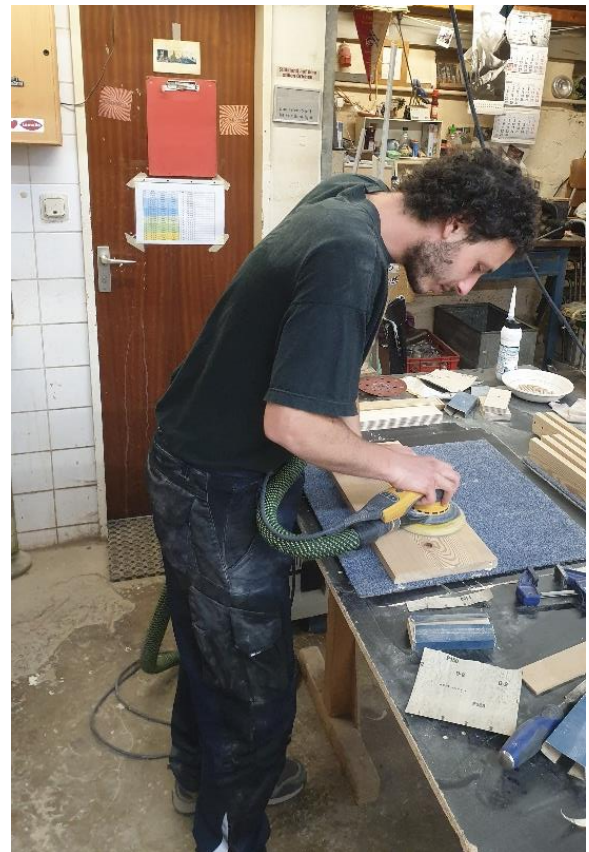
Εικόνα 5.46: Τρίψιμο των μεγάλων επιφανειών με έκκεντρο τριβείο I.
