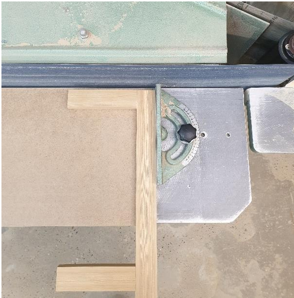
Εικόνα 5.51: Τρίψιμο των ποδιών από πάνω για να αφαιρέσω το "σκαλοπάτι".
