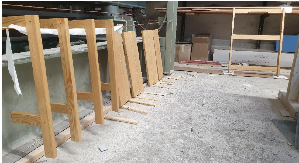
Εικόνα 5.59: Τοποθέτηση των στοιχείων για στέγνωμα.
