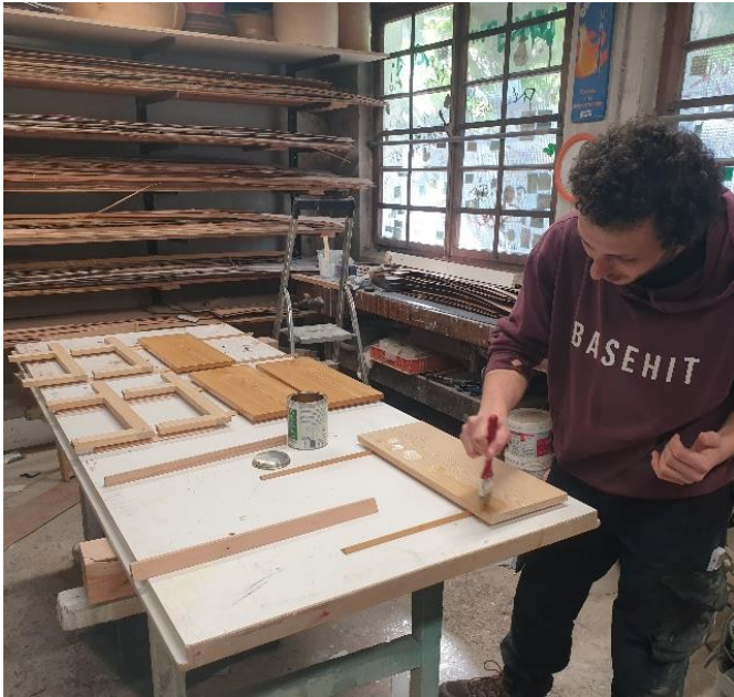
Εικόνα 5.57: Πρώτο χέρι φινιρίσματος με πινέλο.
