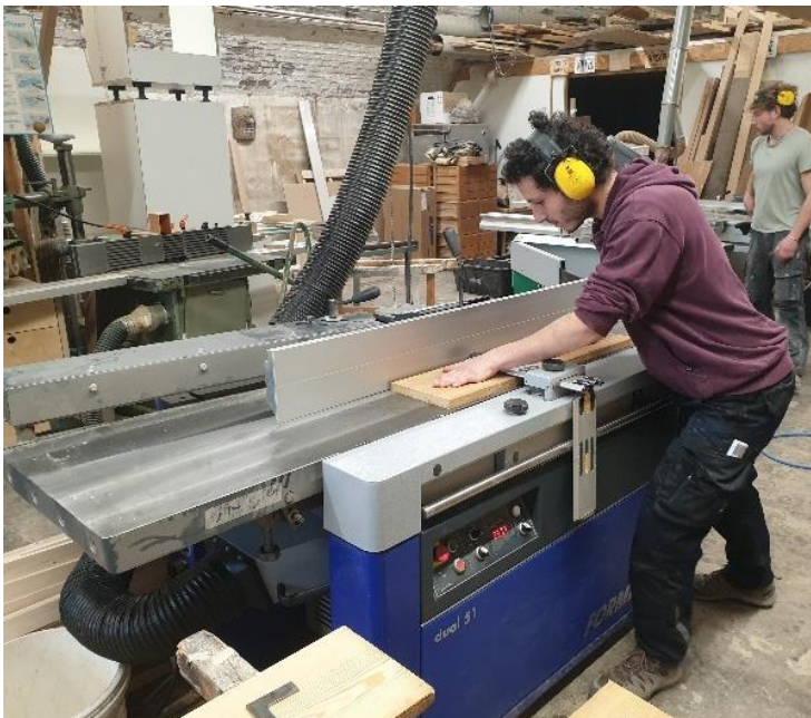
Εικόνα 5.11: Πλάνισμα των στοιχείων, πρώτα την μεγάλη επιφάνεια.
