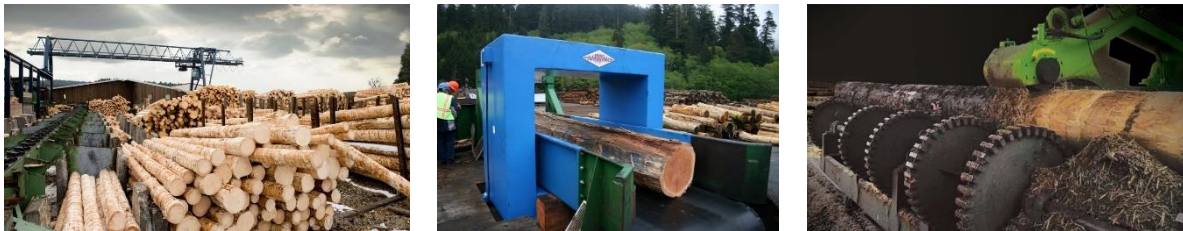
Εικόνα 2.3: Κορμοπλατεία με σύστημα αλυσομεταφορέα, Ανιχνευτής μετάλλων, Αποφλοιωτής κορμών. Από αριστερά προς δεξιά.
