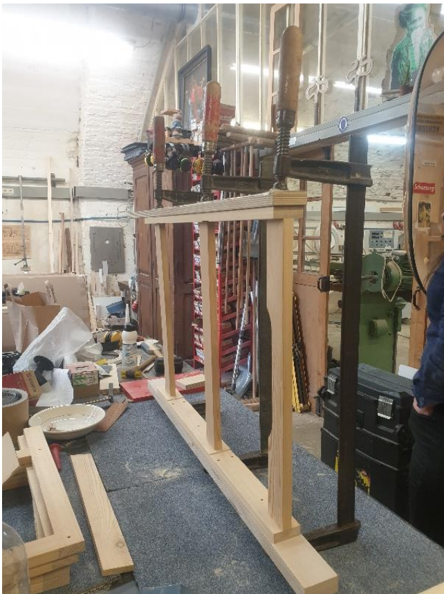
Εικόνα 5.49: Συγκόλληση του σώματος με σφικτήρες.
