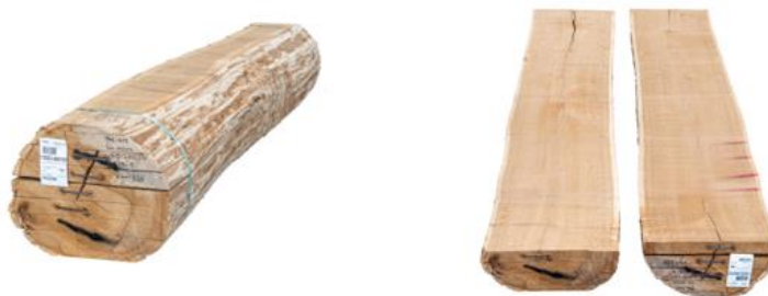
Εικόνα 2.10: Ακατέργαστη ξυλεία δρυός, σε ολόκληρο κορμό τύπου boules.
