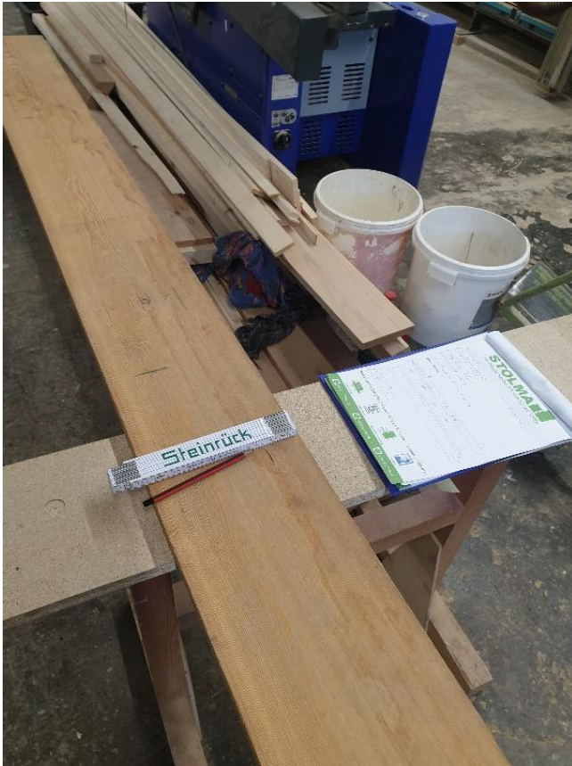
Εικόνα 5.9: Σανίδα σιβηρικής λάρικας μήκους 5,1m, πλάτους 210mm και πάχους 24mm.
