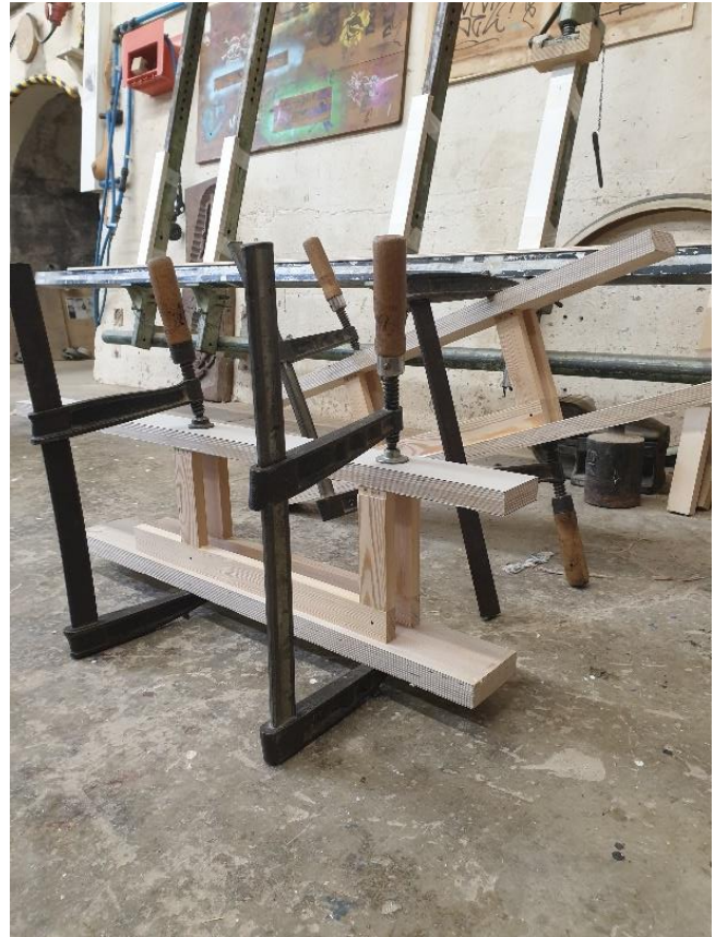
Εικόνα 5.48: Συγκόλληση των ποδιών και σύσφιξη με σφικτήρες.
