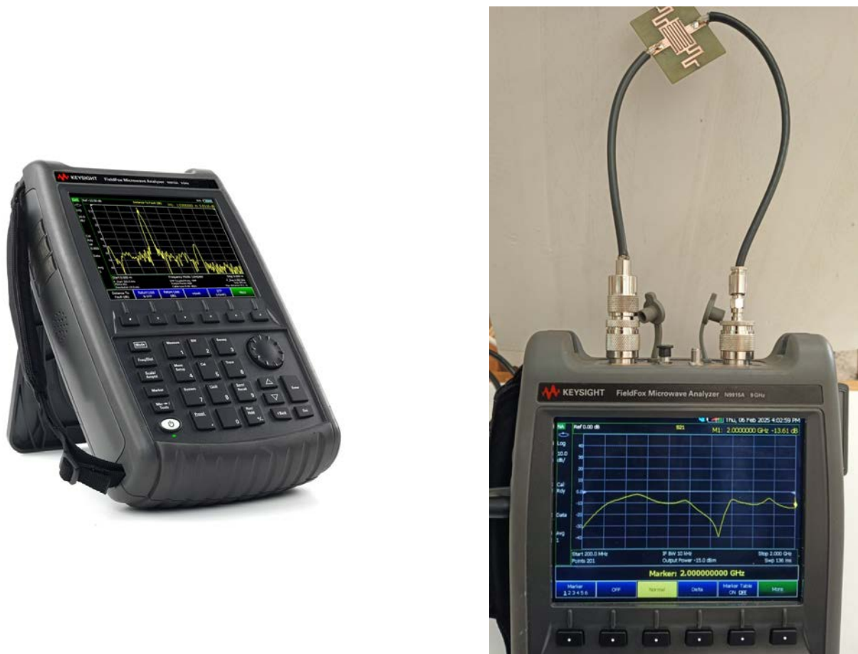
Σχήμα 4.27: Μέτρηση των παραμέτρων σκέδασης ( S_{21} ) της δομής με τον αναλυτή.
