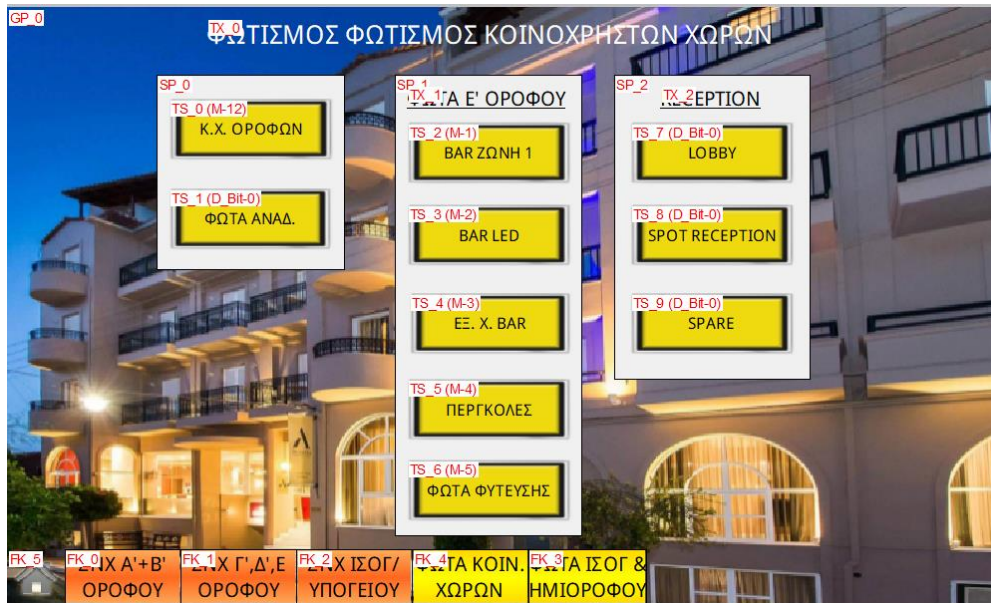
Εικόνα 58 Διαχείριση φωτισμού κοινόχρηστων χώρων
