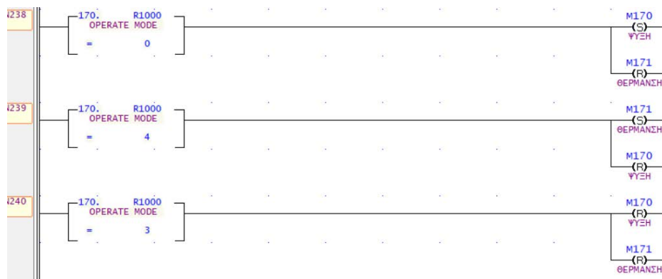
Εικόνα 42 Επιλογή ψύξης/θέρμανσης από το slave PLC λαμβάνοντας εντολή από το master PLC
