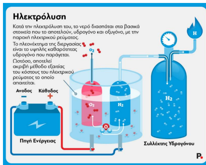
Εικόνα 13 Απεικόνιση παραγωγής υδρογόνου με τη μέθοδο ηλεκτρόλυσης ( kifisia-life.gr/index.php/green-life/item/59588-gallia-germania-symmaxia-gia-to-prasino-ydrogono )
