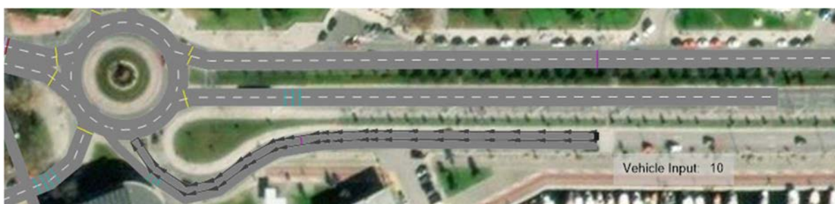
Εικόνα 0.4: Τοποθέτηση φόρτου στην οδό επί του Λιμανιού από τον κόμβο
