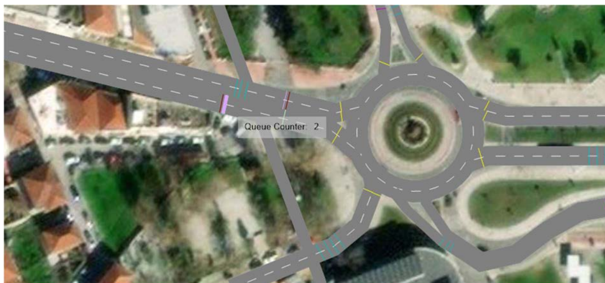
Εικόνα 0.27: Κάτοψη στο Vissim με τα Queue Counters
