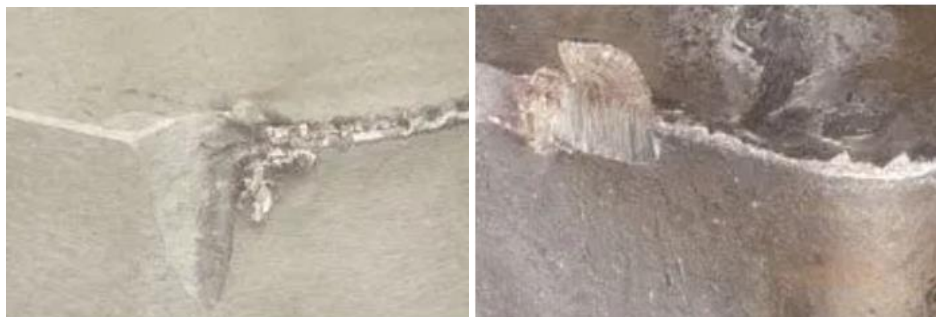
Εικόνα 1-5 Απολέπιση κοπτικού εργαλείου αριστερά, Build-up Edge δεξιά. [13]
