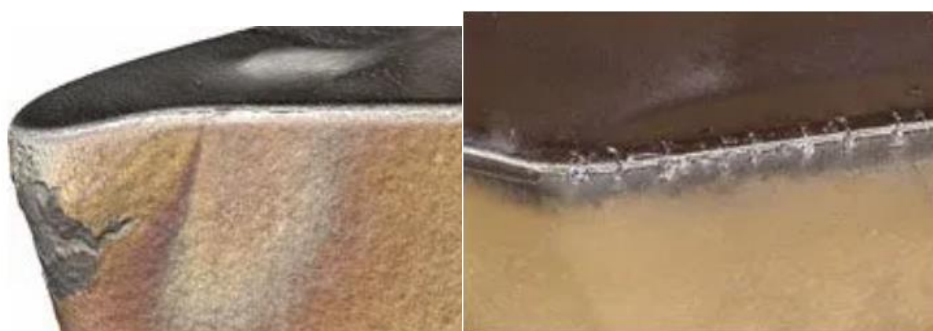
Εικόνα 1-6 Πλαστική παραμόρφωση αριστερά, θερμικές ρωγμές δεξιά.[13]
