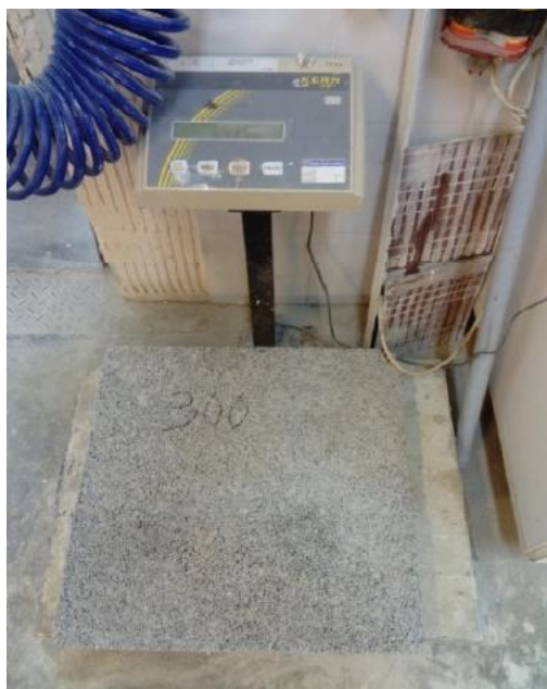
Εικόνα 3.3. Πλάκα 300 kg/m 3 επάνω στην ηλεκτρονική ζυγαριά.
