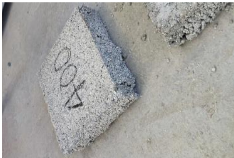
Εικόνα 4.2. Δοκίμιο των 400 kg/m 3 έπειτα από θλίψη.
