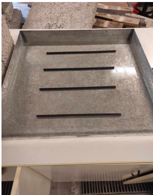
Εικόνα 3.5. Μεταλλικοί αποστάτες διατομής 8mm.
