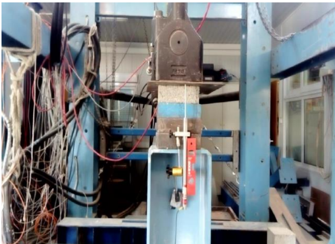
Εικόνα 3.4. Πειραματική διάταξη για δοκιμή σε θλίψη.
