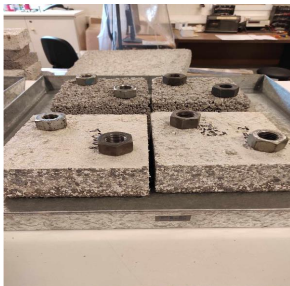
Εικόνα 3.6. Πειραματική διάταξη υδατοαπορροφητικότητας.
