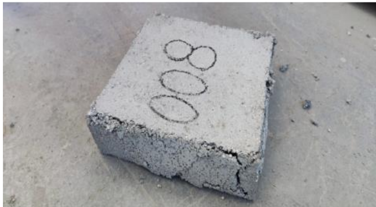
Εικόνα 4.1. Δοκίμιο των 800 kg/m 3 έπειτα από θλίψη
