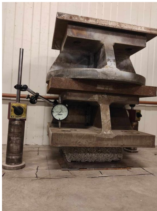
Εικόνα 3.9. Πραγματική πειραματική διάταξη ερπυσμού
