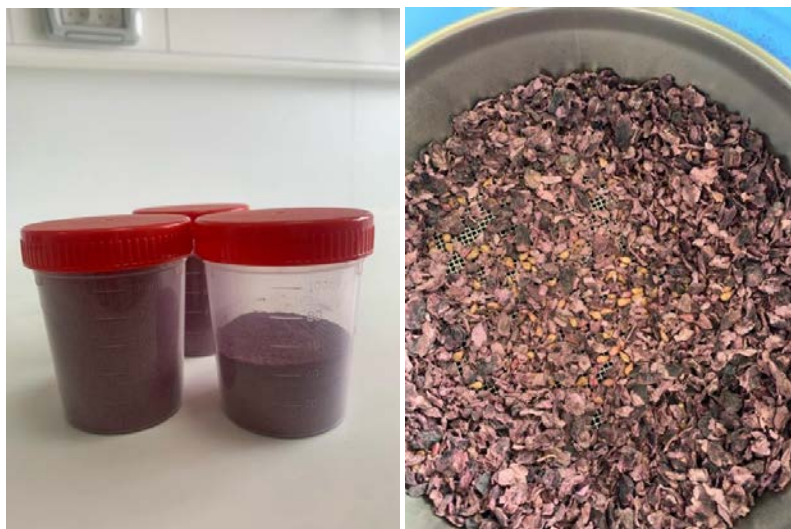
Εικόνα 3.1 και 3.2: Στέμφυλα μετά την ξήρανση και την κονιορτοποίηση
