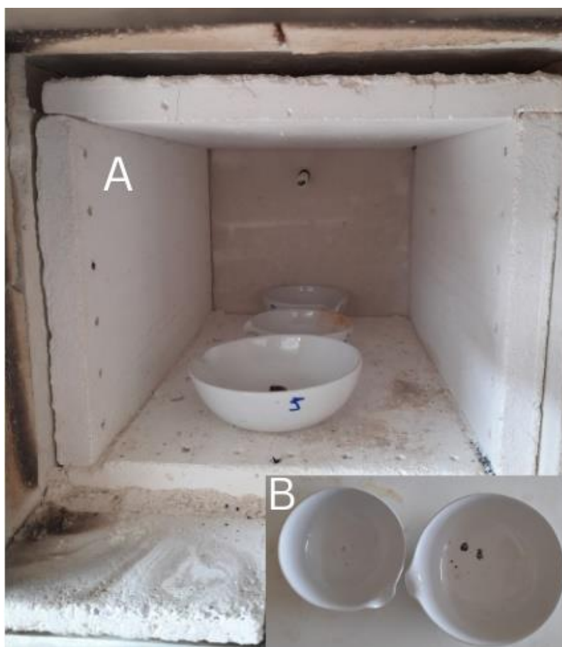
Εικόνα 25. Α) Δείγματα στο πυριατήριο πριν την καύση και Β) Τα δείγματα μετά την καύση για τον προσδιορισμό της τέφρας.
