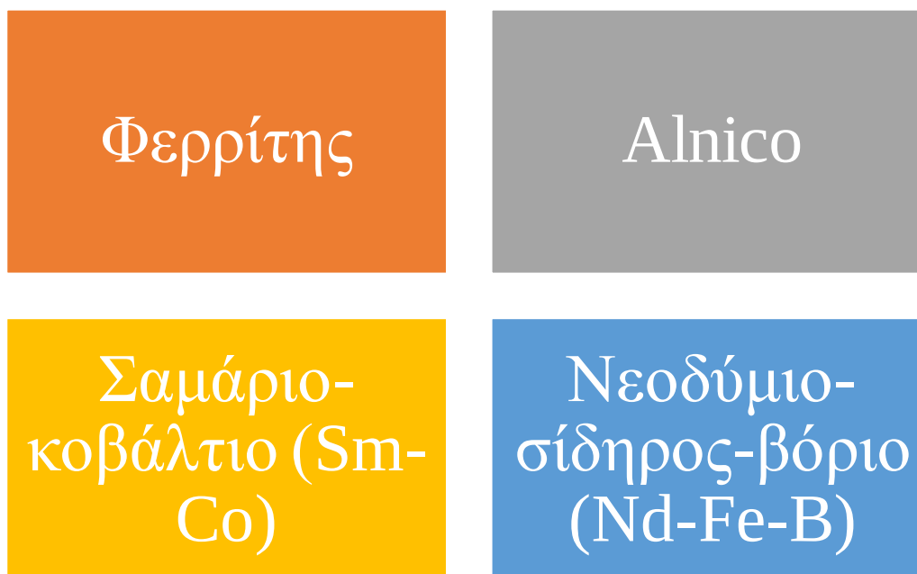
Σχήμα 1: Τύποι υλικών από τα οποία κατασκευάζονται οι μόνιμοι μαγνήτες
