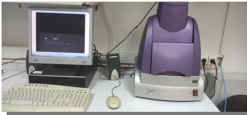
Εικόνα 7: Συσκευή UV για ανάγνωση τζελ (δεξιά) & H/Y για αποτελέσματα (αριστερά)
