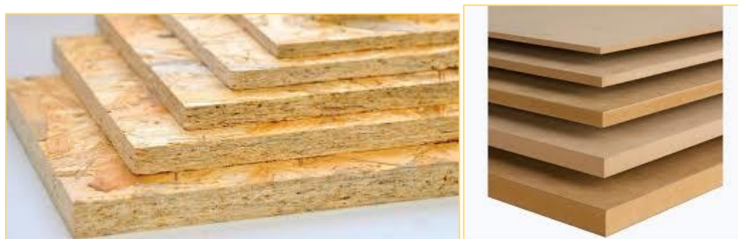
Εικ. 2-3. Ξυλοπλάκες OSB (αριστερά) και MDF (δεξιά).
