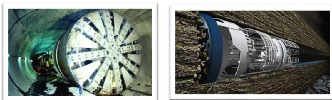
Σχήμα 2.2: Μηχανή ολομέτωπης κοπής
