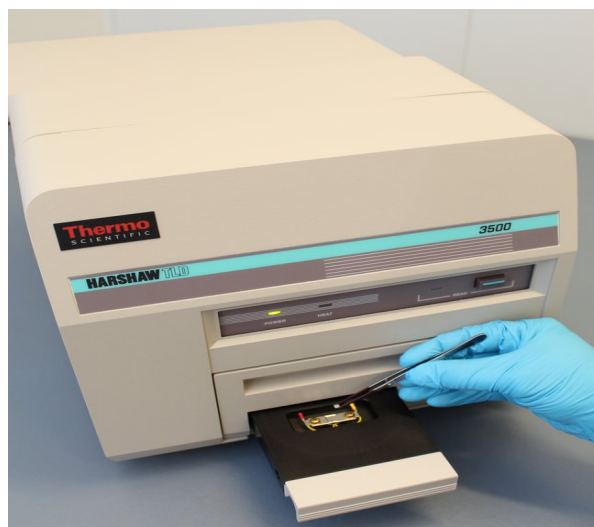
Εικόνα 1.2-3: Η συσκευή μέτρησης της θερμοφωταύγειας αποτελείται από ένα θάλαμο δείγματος, έναν ελεγκτή θερμοκρασίας δείγματος, έναν φωτοπολλαπλασιαστή και ένα μέρος καταγραφής.
