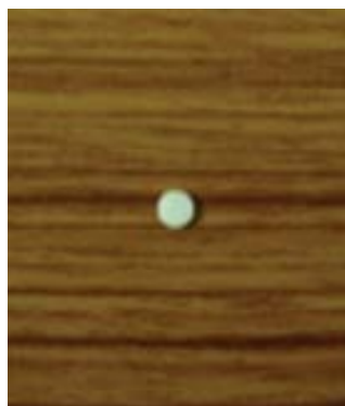
Εικόνα 1.2-1: Δοσιμετρικό δισκίο Οξειδίου του Βηρυλλίου (Πηγή: Tsoutsoumanos, 2018)
